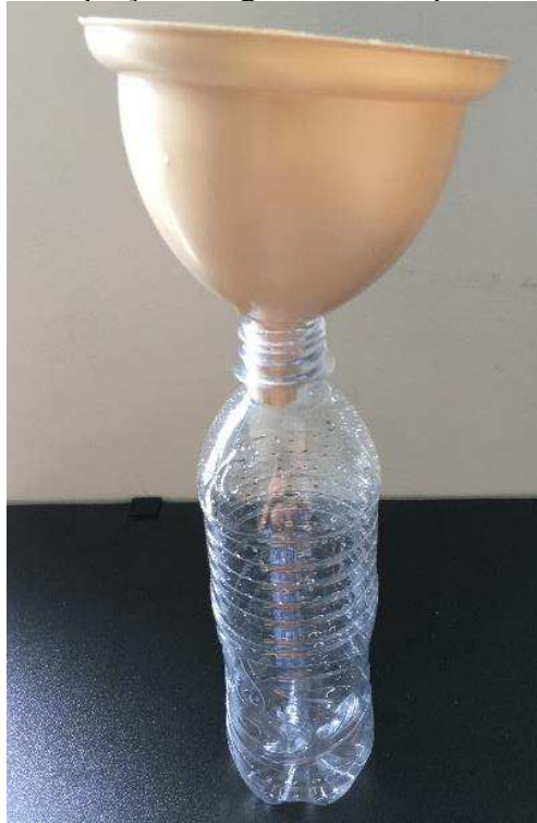
Figura 12: Sistema de captação de água da chuva para análise em laboratório
