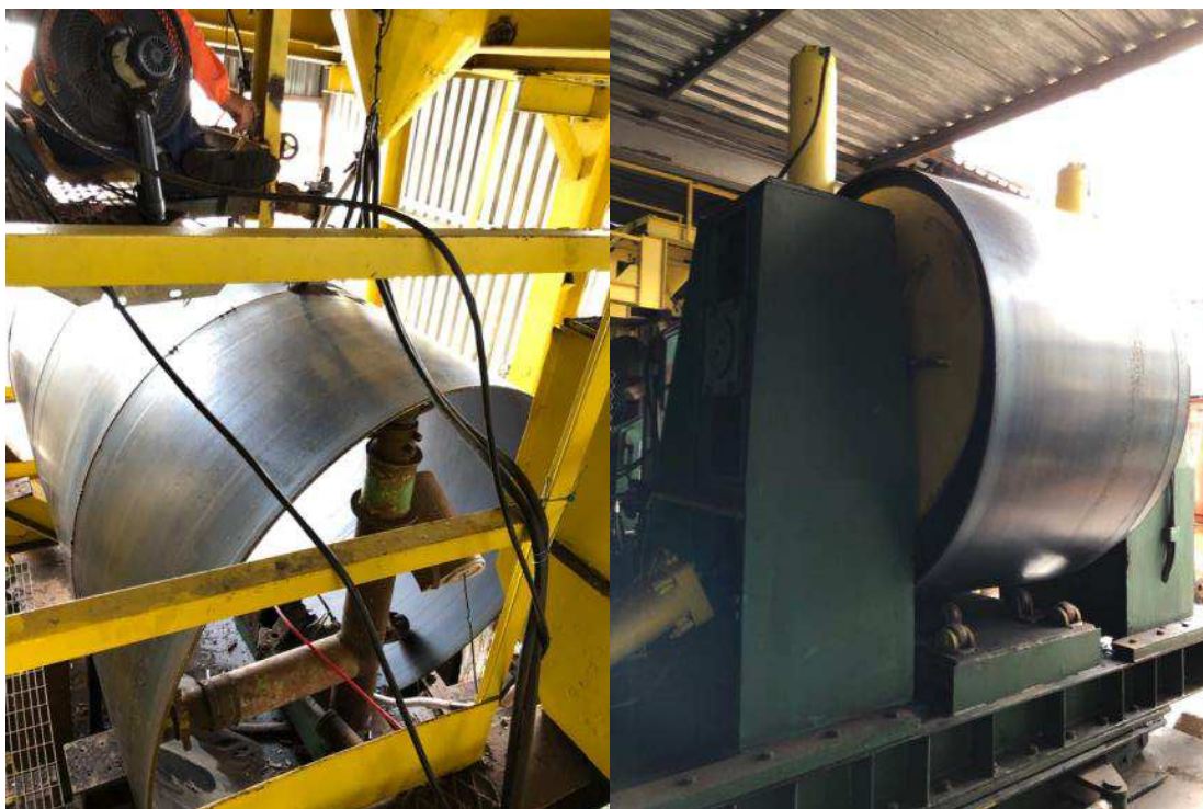
Figura 39: Bobina de chapa metálica e procedimento de soldagem interna e externa de camisa metálica
