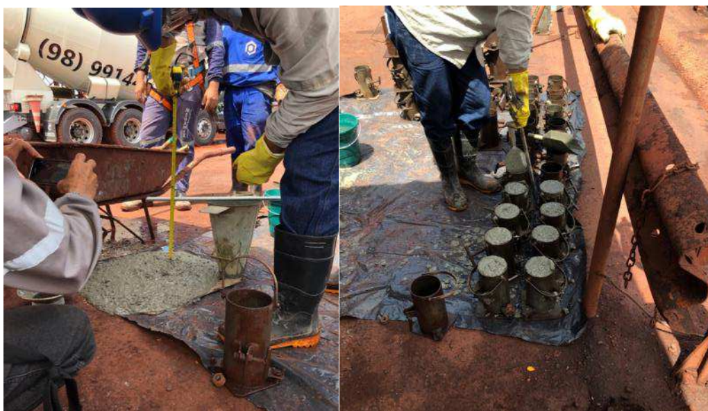
Figura 73: Ensaio de abatimento e preparo de corpos de prova
