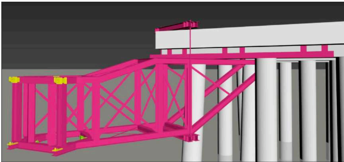
Figura 41: Esquema tridimensional do modulo arranque da guia de cravação
