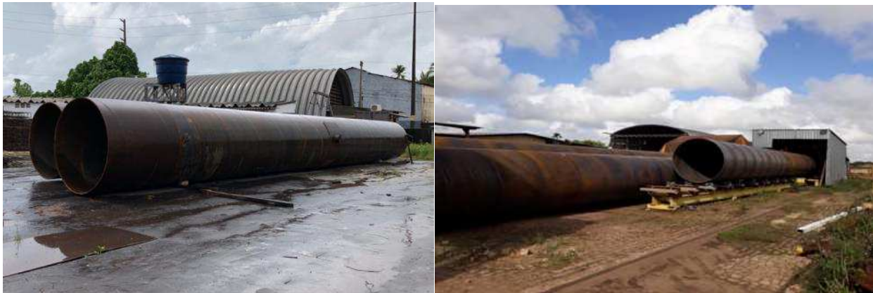
Figura 56: Camisas metálicas aguardando transporte e na esteira de soldagem, conforme projeto 3250KP-C-22041
