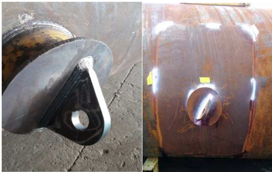
Figura 63: Olhais das camisas metálicas
