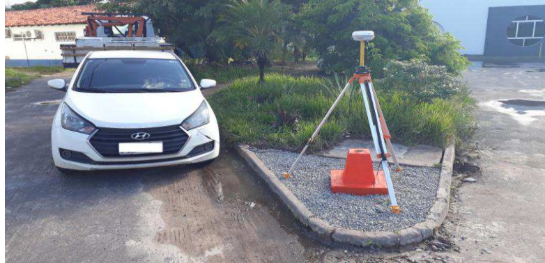
Figura 43: Receptor TRIMBLE R4-3 coletando dados GNSS, alimentado por bateria automotiva.
