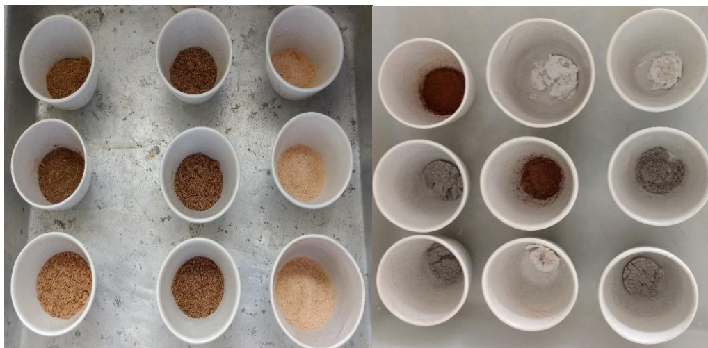
Figura 9 - Material pré-queima em forno mufla e material pós-queima em forno mufla. Fonte: COSTA, 2017.
