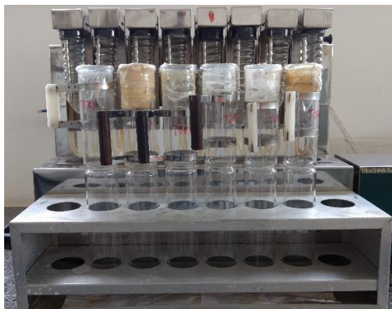
Figura 10 - Bloco digestor de fibra. Fonte: COSTA, 2017.
