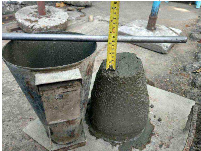
Figura 10 - Aferição da diferença no Slump Test.
