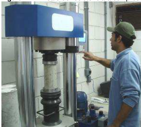
Figura 11 - Ensaio de resistência a compressão característica
