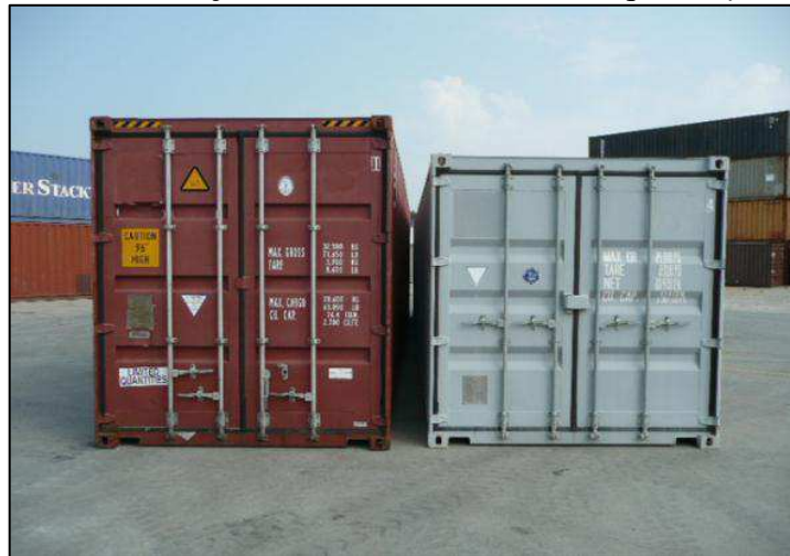
Figura 11 - Diferença entre contêiner 40' HC (esq.) e Dry 40' (dir.)
