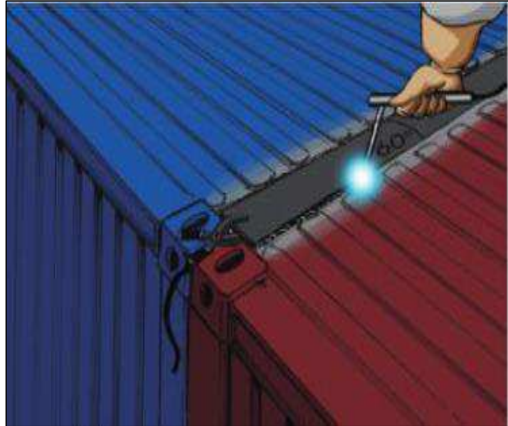
Figura 19 - Interface Superior entre Contêineres
