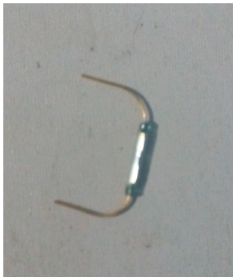
Figura 8 – Reed switch usado no projeto
