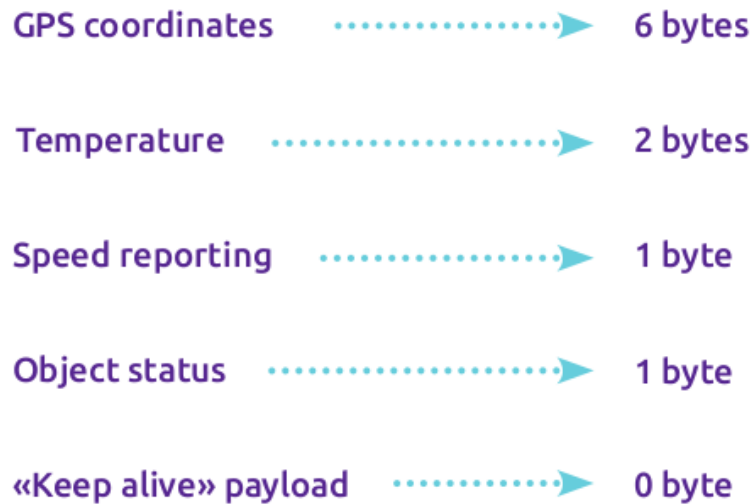
Figura 4 - Exemplo de tamanho de payload Sigfox 15
