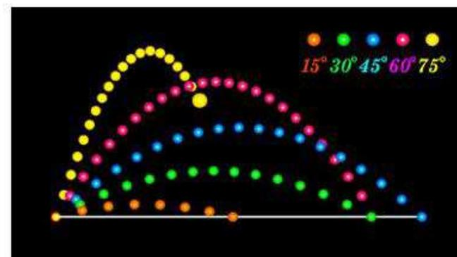
A altura máxima de um objeto lançado será determinada a partir da equação de Torricelli, equação do movimento uniformemente variado independente do tempo.
