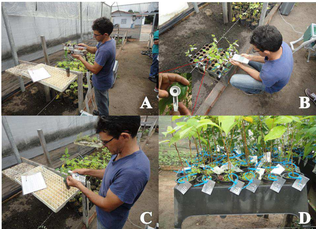
Figura 12. Coleta de dados referentes aos parâmetros ecofisiológicos em condições de viveiro. Coleta de dados com o IRGA (A), fluorímetro (B) e SPAD (C), identificação numérica das mudas (D).
