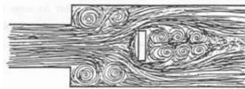
Figura 12 - Desenho produzido por Leonardo da Vinci em que procura representar graficamente o escoamento do vento em torno de um obstáculo.
