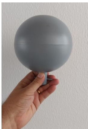
Foto 5 - Foto do globo cinza utilizado para a geração da temperatura radiante média
