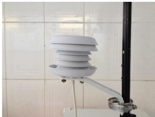
Foto 6 - Termohigrômetro digital protegido por solar shield
