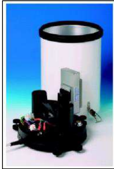
Figura 3: Pluviógrafo com mecanismo de registro em meio magnético
