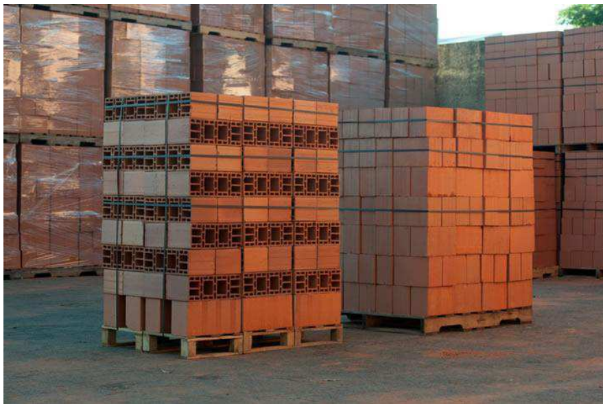
Figura 27 – Paletização De Blocos Cerâmicos Estruturais
