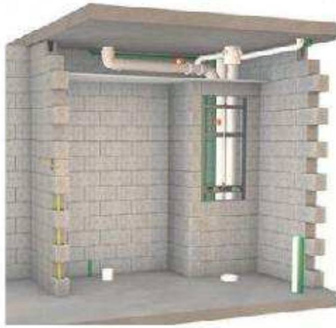
Figura 25 – Representação de um Shaft Hidráulico
