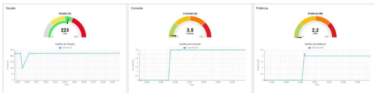
Figura 19 – Monitoramento de tensão, corrente e potência
