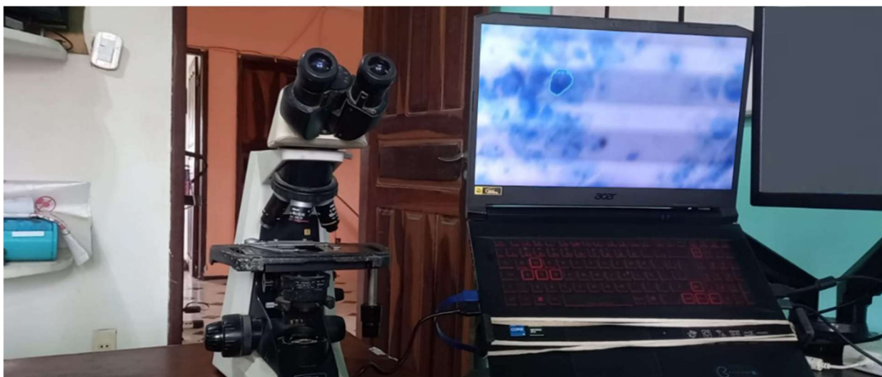
Figura 18 – A câmera CMOS de 2MP demonstrou qualidade de imagem inferior com barras verticais deslizantes, o que na prática afetou a detecção de células cervicais
