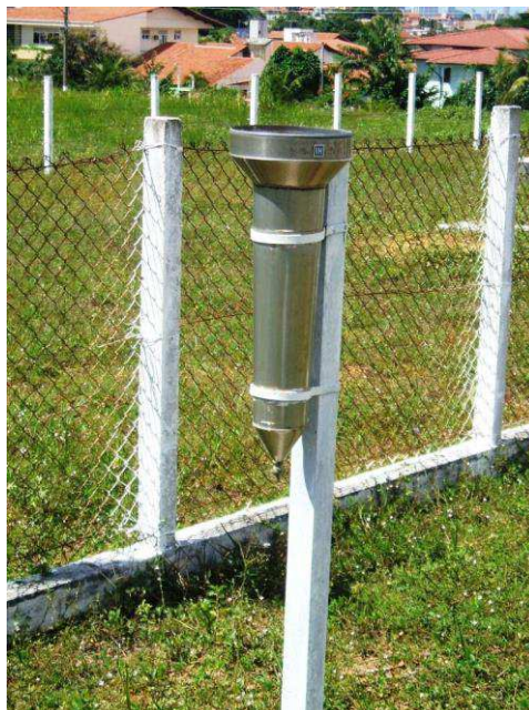
Figura 3 - Pluviômetro "Ville de Paris"
