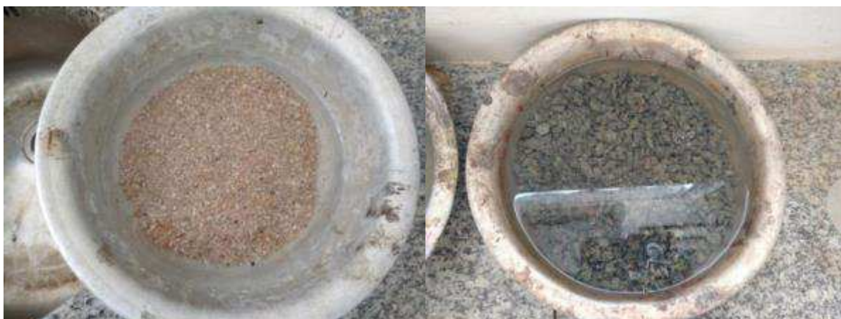
Figura 34 - Amostras de areia e brita cobertas com água
