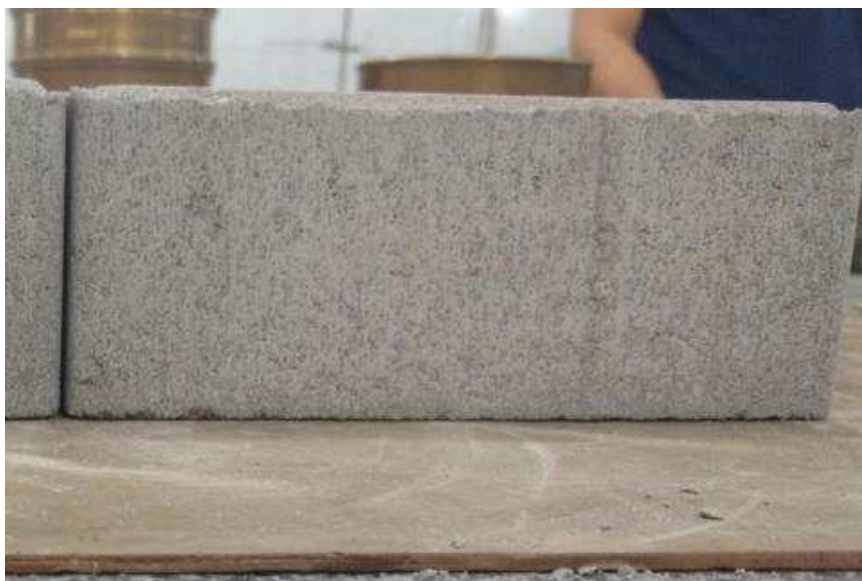
Figura 58 - Vista lateral de uma das PPC utilizadas no ensaio de inspeção visual
