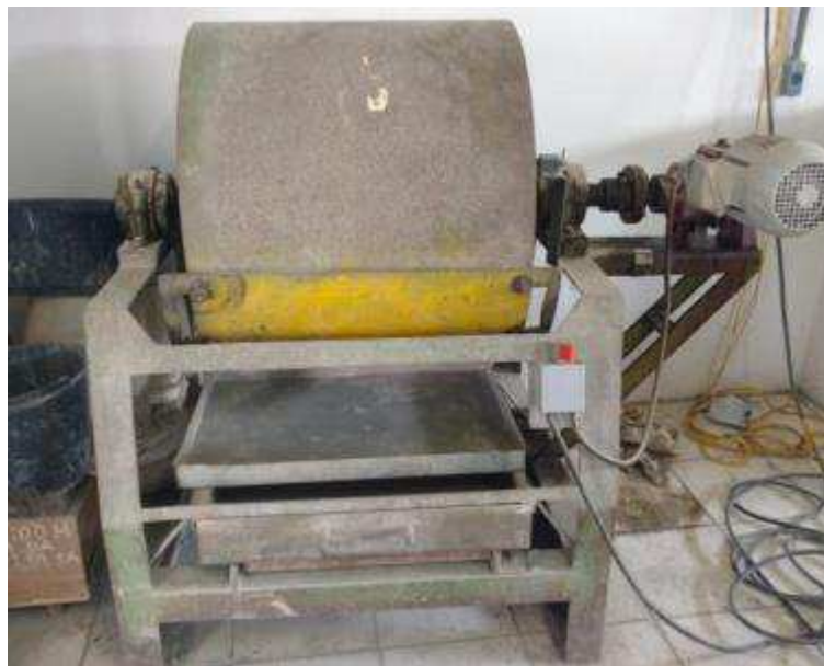
Figura 36 - Máquina de abrasão a "Los Angeles"
