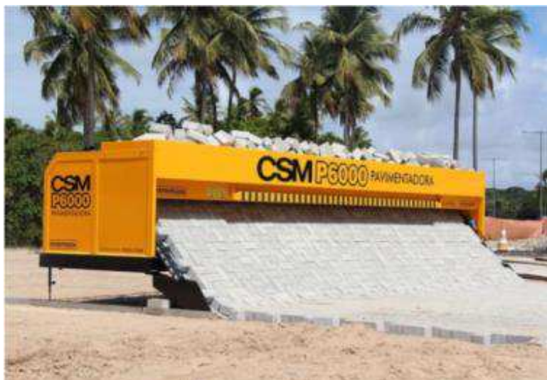
Figura 28 - Pavimentadora automática de paver (1)
