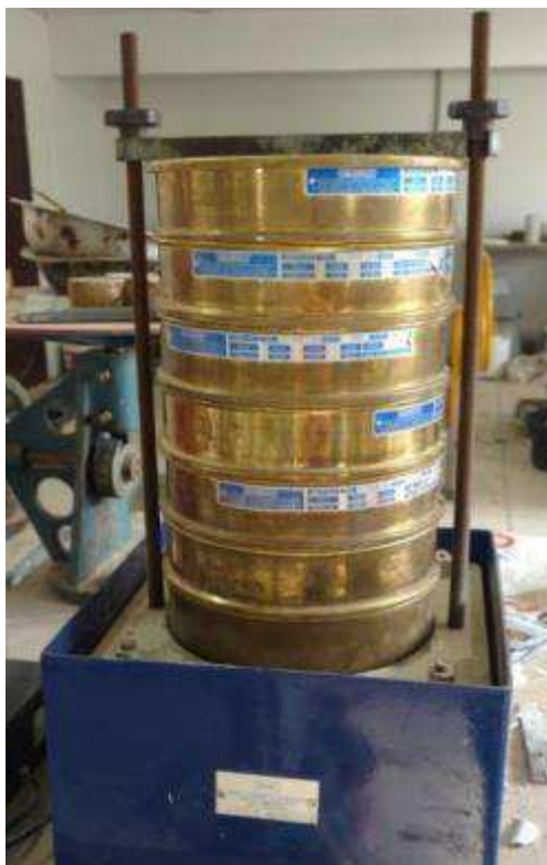
Figura 33 - Conjunto de peneiras com fundo e tampa no agitador mecânico
