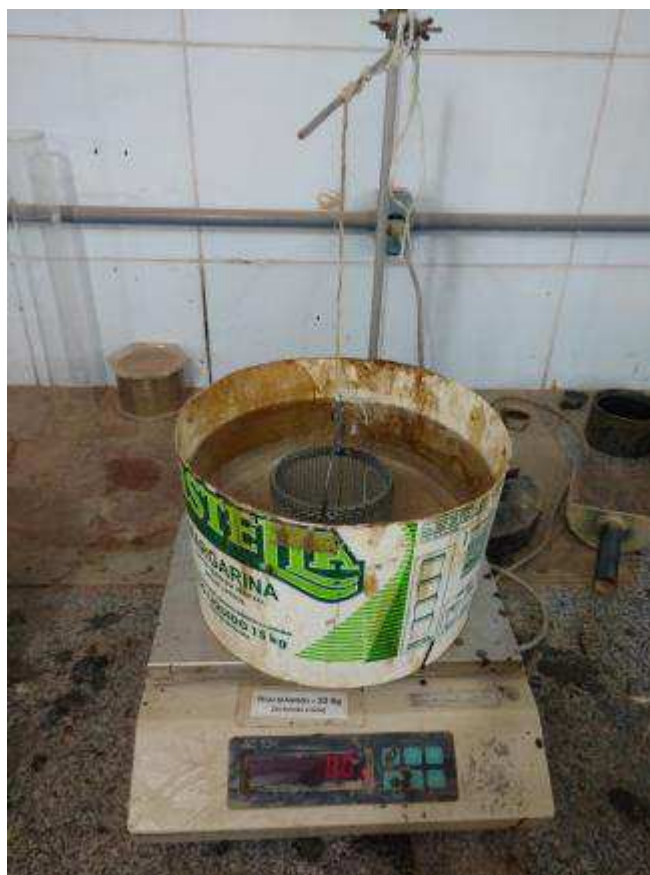
Figura 38 - Recipiente com água e cesto zerados na balança
