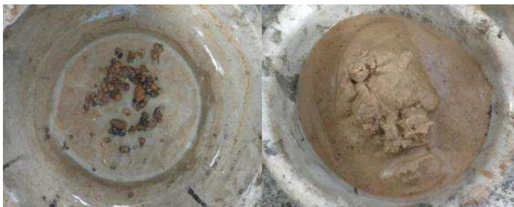
Figura 42 - Amostras de solo retidas nas peneiras 2,00 mm e 0,075 mm (respectivamente)
