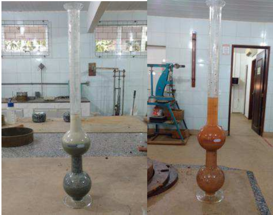
Figura 37 - Realização do ensaio de densidade de agregados miúdos
