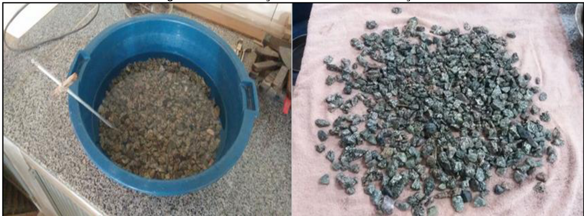
Figura 18 – Execução do ensaio de absorção.
