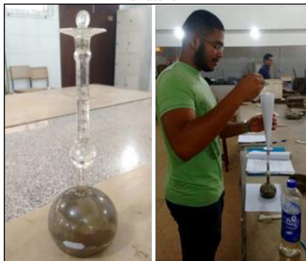
Figura 25 – Determinação da massa específica do cimento Portland pelo Frasco Le Chatelier.
