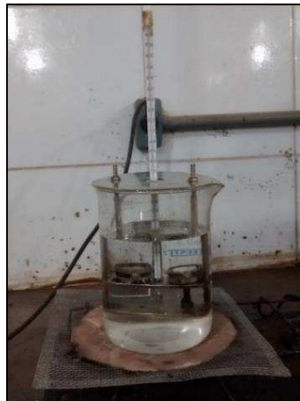
Figura 26 – Momento em que a amostra toca a placa de referência.
