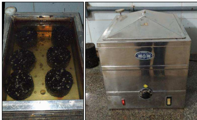
Figura 34 – Corpos de prova em banho-maria.
