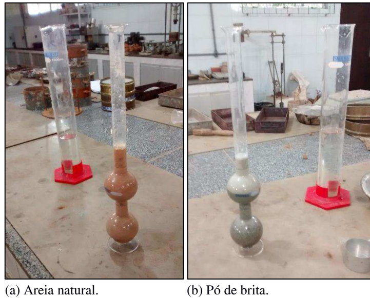
Figura 20 – Determinação da massa específica pelo frasco Chapman.
