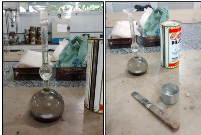
Figura 21 – Conjunto querosene/fíler no frasco Le Chatelier.
