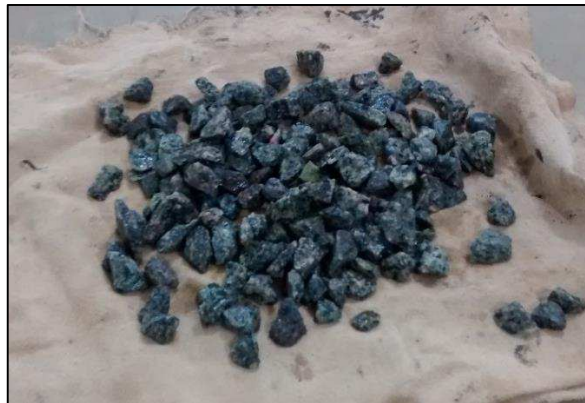
Figura 14 – Amostra espalhada sobre pano absorvente.
