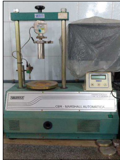
Figura 35 – Prensa Marshall utilizada para a determinação da estabilidade, fluência e resistência à tração.
