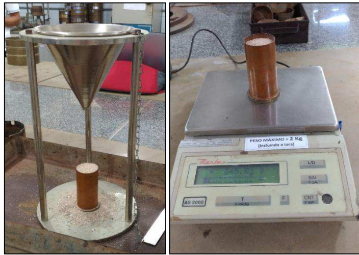
Figura 18 – Ensaio de angularidade.
