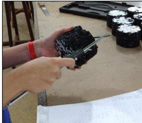
Figura 33 – Determinação da altura do corpo de prova.
