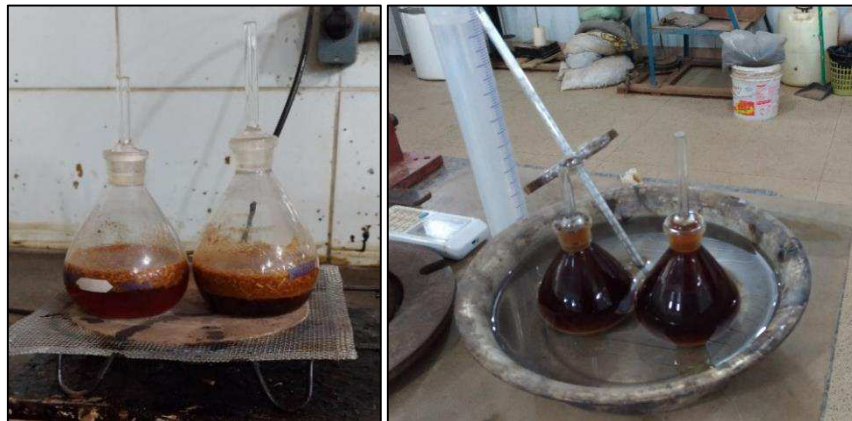
(a) Amostras sendo fervidas.
