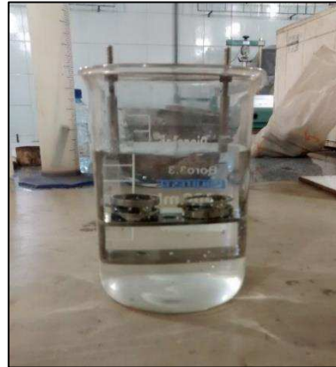
Figura 25 – Realização do ensaio de ponto de amolecimento.
