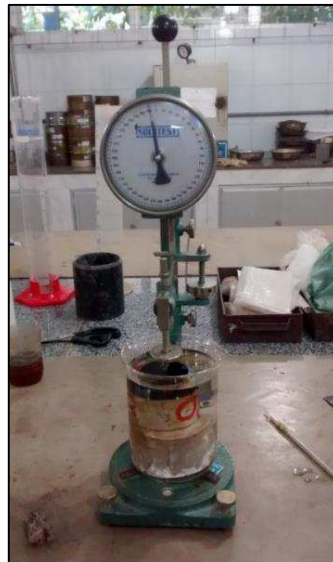
Figura 23 – Realização do ensaio de penetração.
