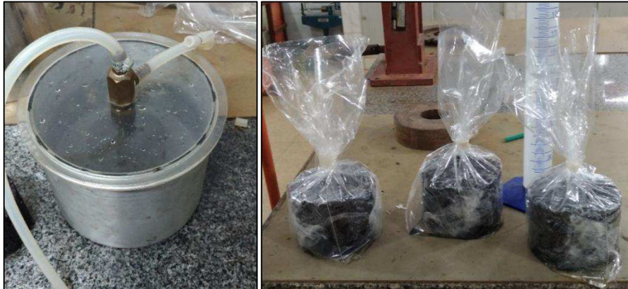
(a) Saturação dos CP's em câmara a vácuo.
