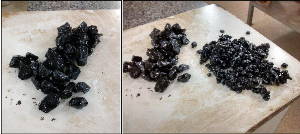
Figura 38 – Adesividade a ligante betuminoso após 72 horas.
