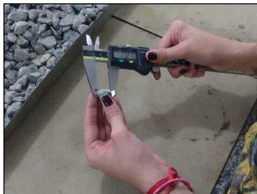
Figura 13 – Determinação das medidas do agregado através de paquímetro digital.
