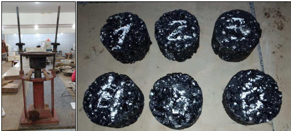
Figura 31 – Desmolde dos corpos de prova.
