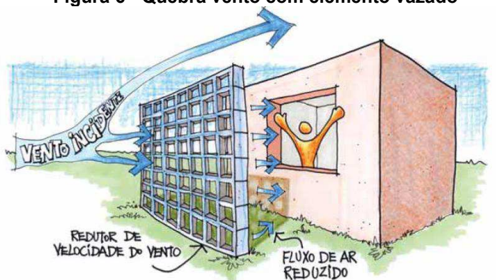
Figura 6 - Quebra vento com elemento vazado
