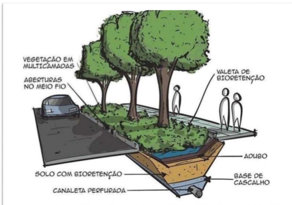
Imagem 15 - Infraestrutura verde: Valetas de biorretenção
