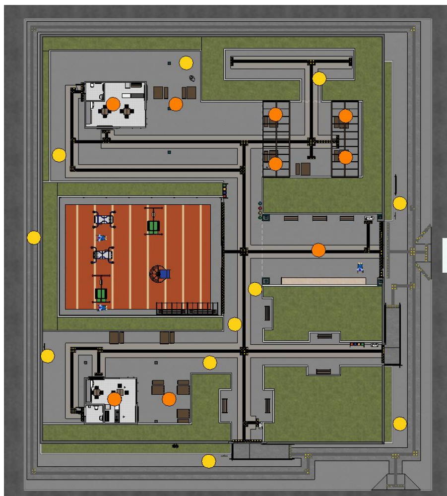
Figura 92 - Planta de pontos de iluminação
