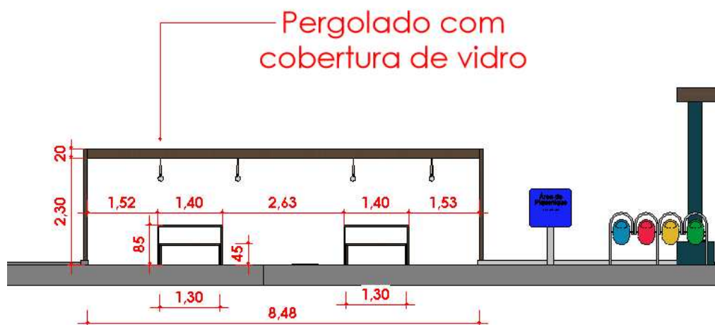
Figura 97 - Corte que evidencia as medidas do pergolado da área de piquenique
