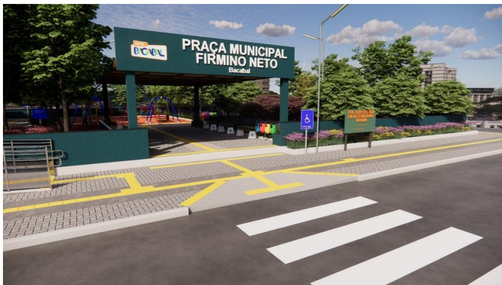
Figura 64 - Vista Renderizada da Guia Rebaixada – Entrada Principal
