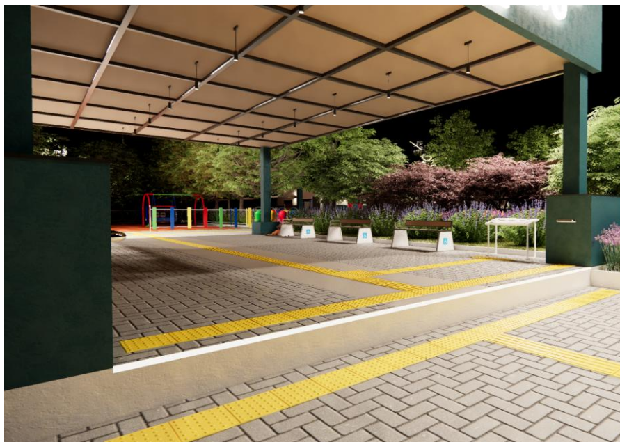
Figura 119 - Sinalização do degrau isolado
