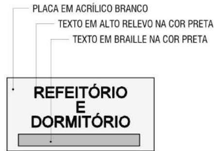
Figura 46 - Placa de identificação de ambiente
