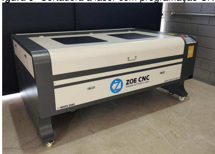
Figura 9- Cortadora a laser com programação CNC.
