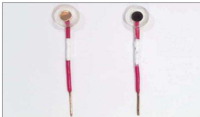
FIGURA 10 – Eletrodos de cobre e eletrodo de cobre revestido com Ni-In eletrodepositado.
