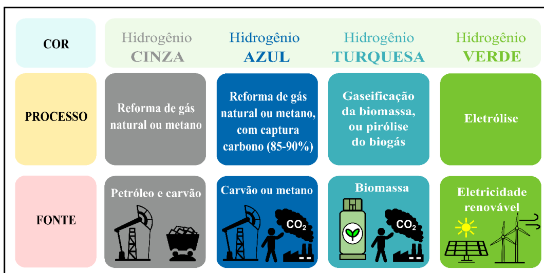
FIGURA 2 – Esquema de cores e processos de obtenção do hidrogênio combustível.
