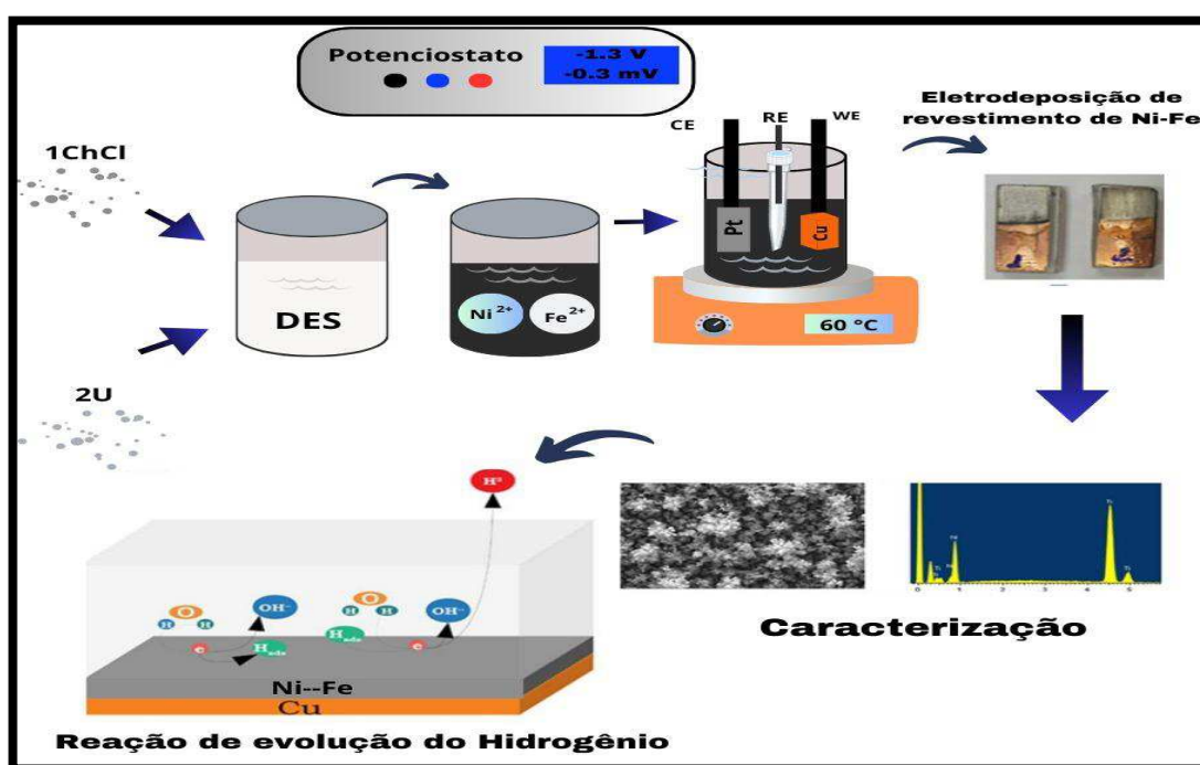
FIGURA 8 – Resumo gráfico da metodologia seguida durante o processo de eletrodeposição e caracterização dos revestimentos.
