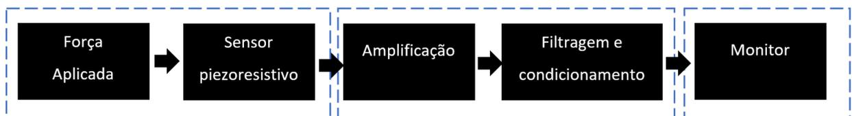
Figura 22 – Sistema de aquisição.
