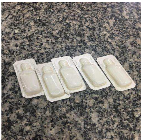
Figura 2: Reagentes do Colilert® utilizados para realização das análises microbiológicas da água.
