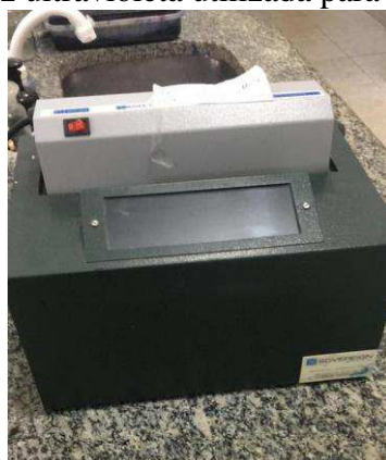
Figura 7: Câmara escura com luz ultravioleta utilizada para leitura de E. coli .
