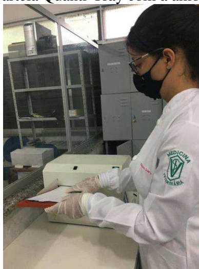
Figura 5: Vedação da cartela Quanti-Tray com a amostra de água na seladora.
