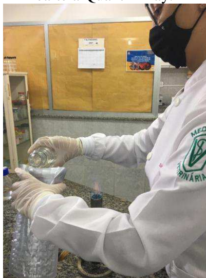
Figura 4: Amostra de água homogeneizada com o reagente do Colilert® adicionada na cartela Quanti- Tray.
