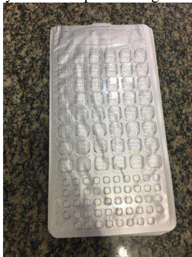
Figura 3: Cartelas Quanti-tray utilizadas para contagem de coliformes a 35° C e E. coli .
