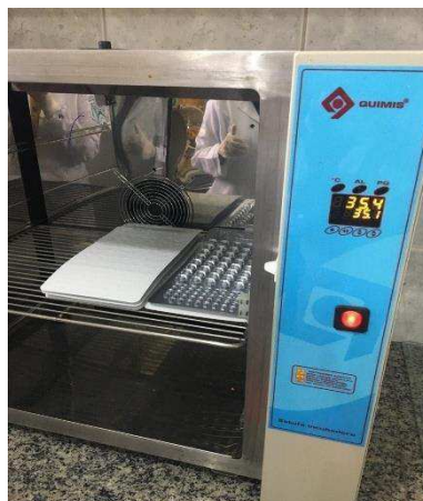
Figura 6: Cartelas Quanti-Tray dispostas na estufa bacteriológica a 35^{\circ}\text{C} \pm 0,5^{\circ}\text{C}/24 horas.
