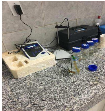
Figura 8: Análise do pH com a utilização do pHmetro portátil.
