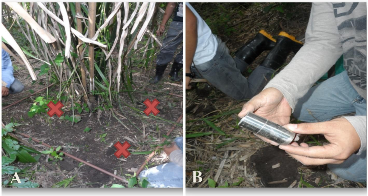
Figura 2. (A) Ponto amostral ‘perto’ de babaçu com três furos (X) para amostras compostas de mesofauna; (B) Cilindro de amostragem.
