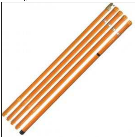
Figura 4-Bastões de manobra elétrica
