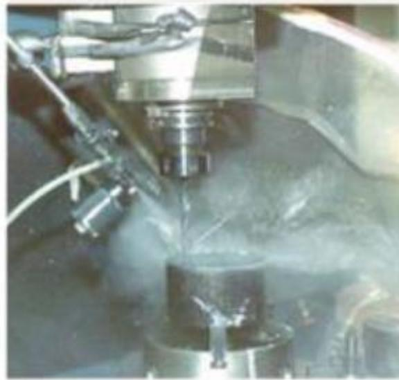
Figura 11: MQF aplicado em processo de furação.
