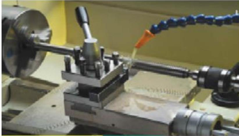
Figura 1: Fluido de corte em ação.
