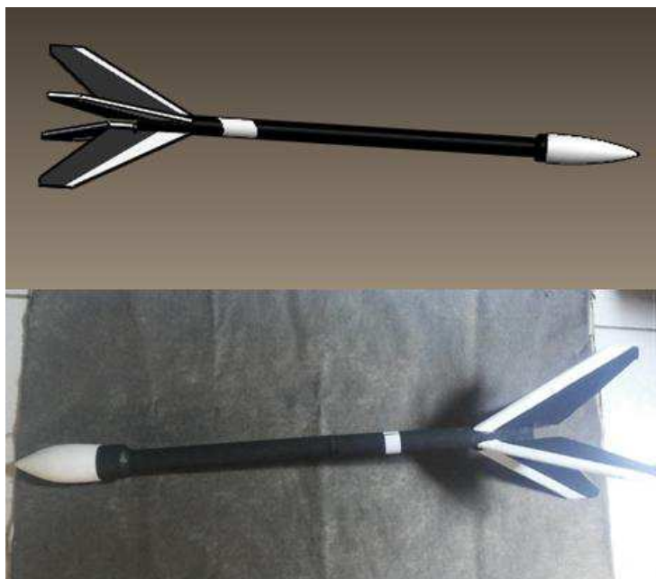
Figura 47: Comparativo entre a modelagem no SolidWorks 2013 e o modelo real.
