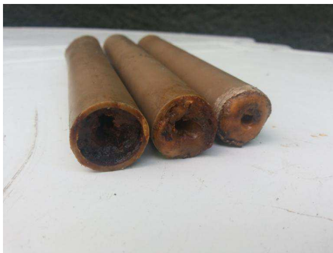
Figura 49: Grãos com defeitos nas faces.
