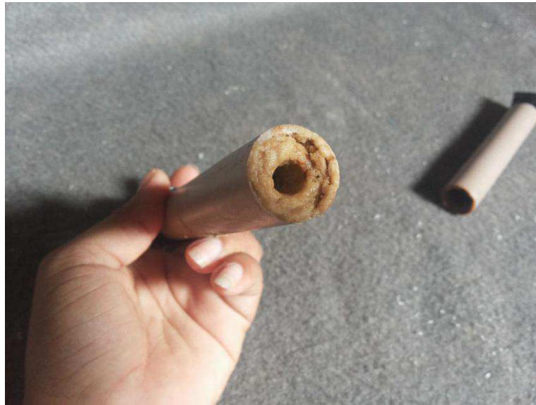
Figura 35: Grão propelente na forma tubular.
