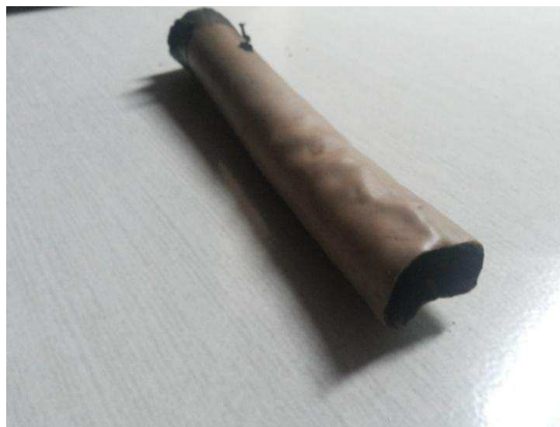
Figura 37: Condições do motor de PVC após a queima do propelente.
