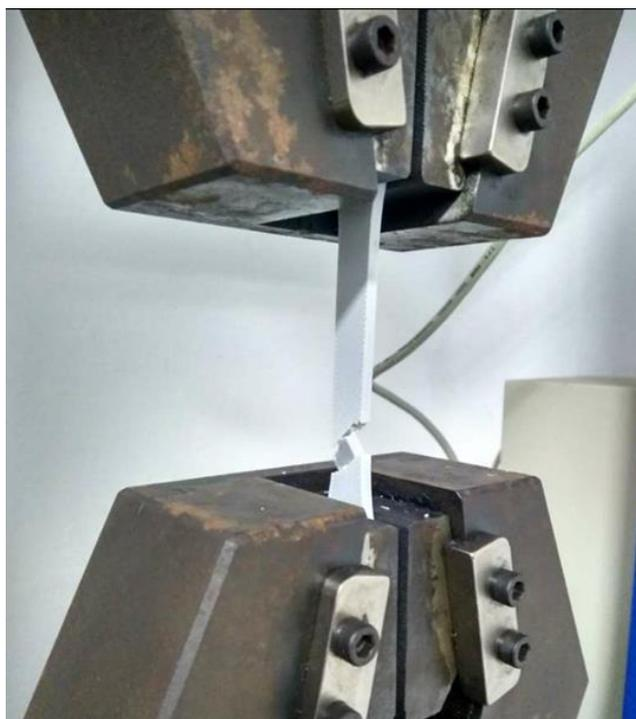
**Figura 3.10** Ensaio de tração no Modelo D
