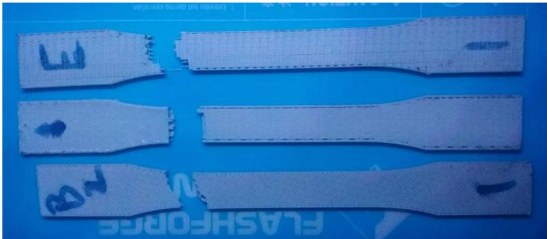
Figura 4.12 Modos de fraturas dos corpos de prova
