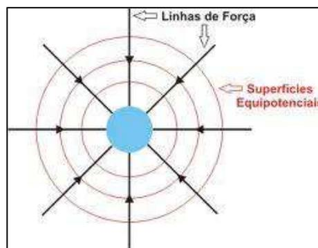
**Figura 18.** Linhas de força sobre uma superfície equipotencial. (Fonte: Google imagens).
