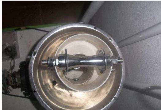
**Figura 31.** Conjunto: Roletes superior e inferior, cano de PVC e tigela
