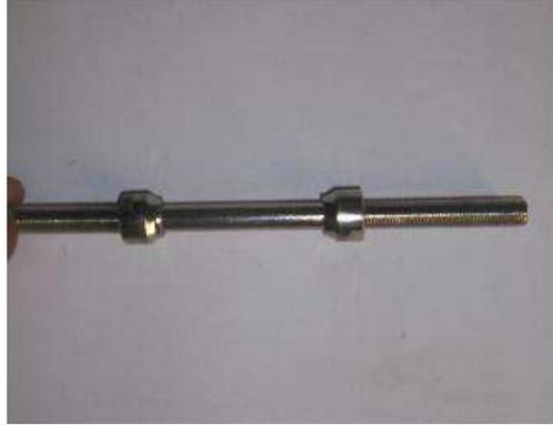
**Figura 24.** Eixo de um cubo de bicicleta.
