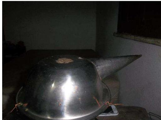
**Figura 34.** Tigela de metal na parte superior do gerador de Van de Graaff
