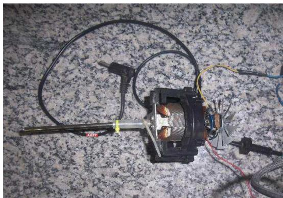
**Figura 21.** Motor de Liquidificador
