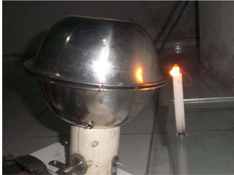
**Figura 36.** Gerador (sem aleta pontiagudo) próximo à vela.
