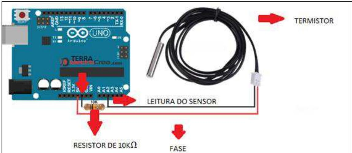
Figura 18: Montagem do circuito do sensor.
