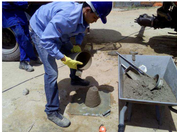
Figura 12 - Retirada do molde do corpo de prova
