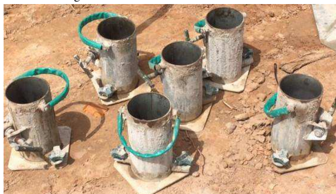
Figura 14 - Moldes cilíndricos 10x20 cm
