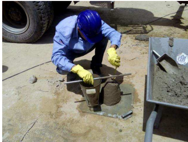
Figura 13 - Medição do abatimento do concreto
