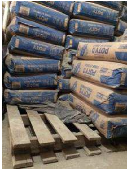
Figura 2 - Modo de armazenamento do cimento Portland
