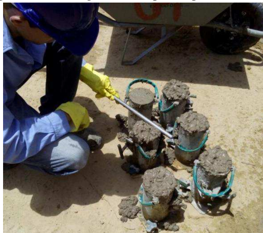
Figura 16 - Moldagem dos corpos de prova cilíndricos
