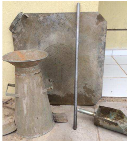
Figura 10 - Equipamentos para a realização do ensaio do Slump Test
