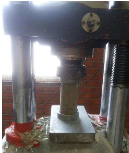
Figura 17 - Rompimento do corpo de prova
