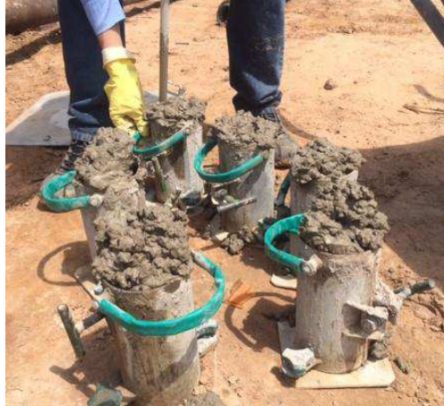
Figura 15 - Adensamento com 12 golpes na camada de concreto
