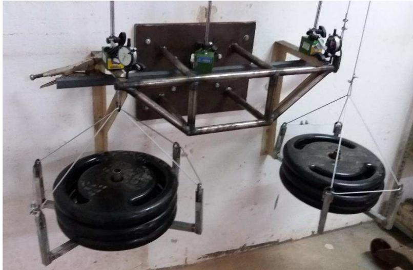
**Figura 3.26 - Protótipo sujeito a Carga Máxima**
