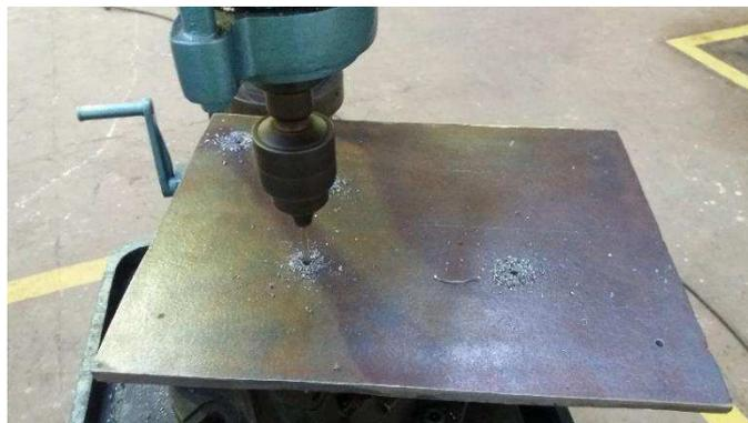
**Figura 3.18 - Uso da Furadeira de Coluna para executar furos de fixação da chapa base**
