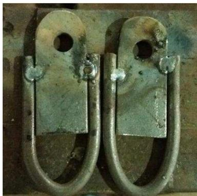
**Figura 3.19 - Suporte para aplicação da Carga**
