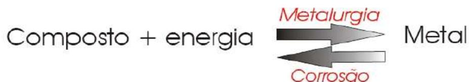
Figura 6 - Comportamento corrosivo do processo metalúrgico
