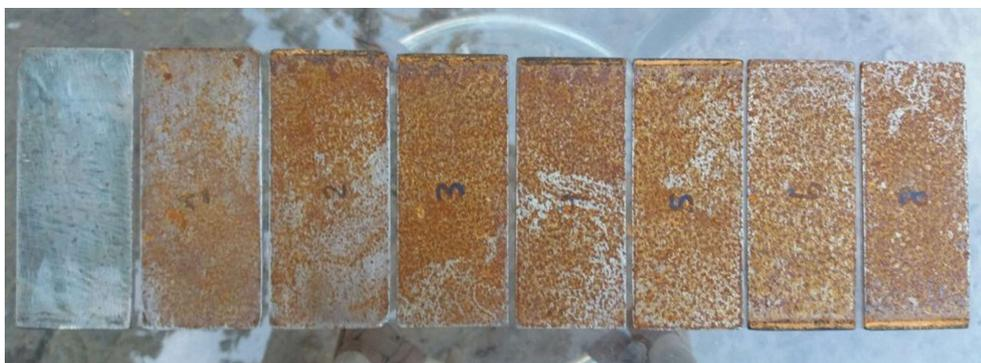
Figura 35 - Propagação da corrosão nos corpos de prova
