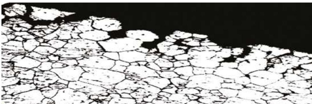
Figura 16 - Corrosão intergranular
