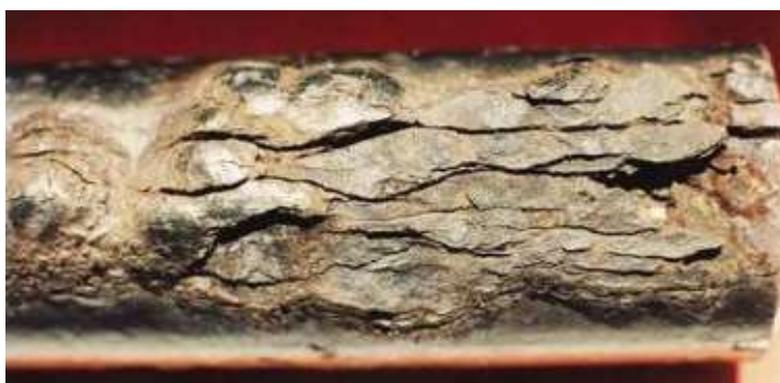
Figura 17 - Esfoliação em tubo de aço-carbono
