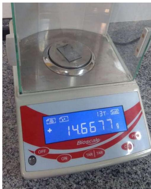
Figura 41 – Pesagem do corpo de prova depois do ensaio
