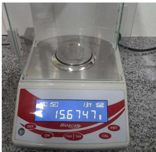
Figura 40 – Pesagem do corpo de prova antes do ensaio
