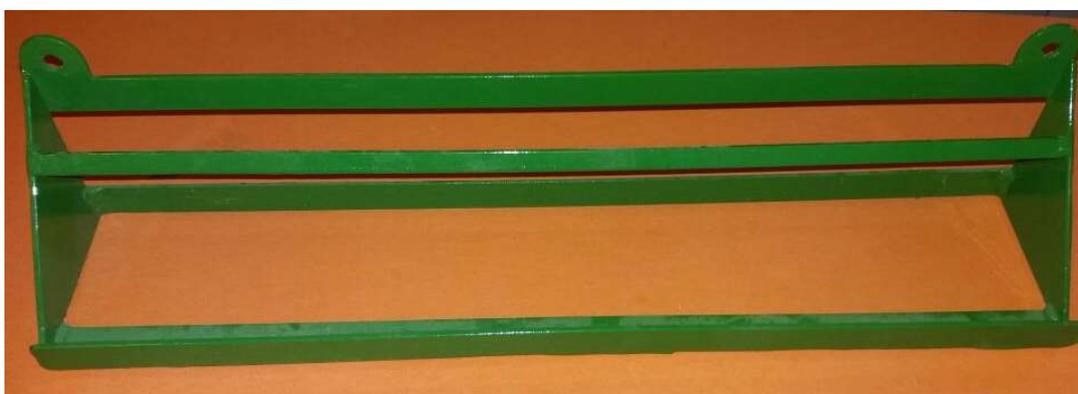
Figura 24 – Suporte para os corpos de prova
