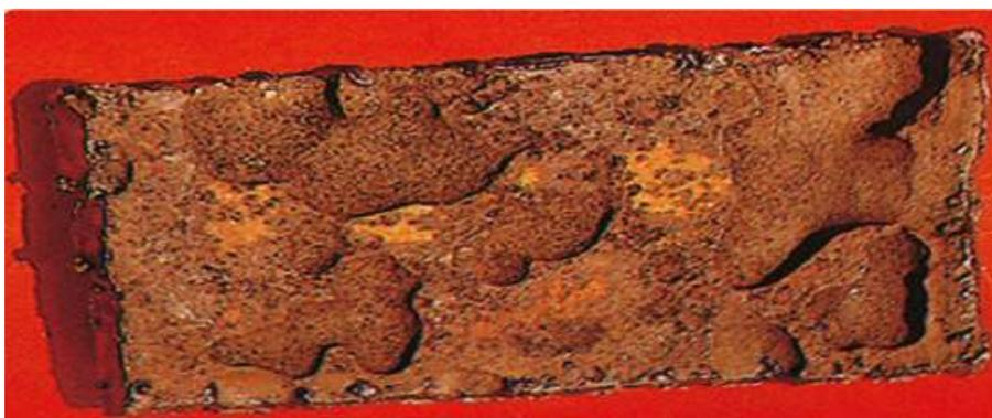
Figura 13 - Corrosão por placas
