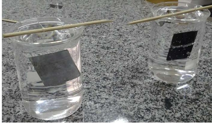
Figura 28 – Peça submersa na solução de NaCl
