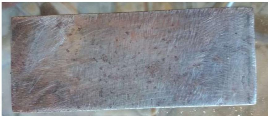
Figura 23 – Corpo de prova com as dimensões: 110 mm x 45 mm x 1,5mm.
