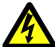
Figura 30. Sinalização de alerta risco de choque elétrico
