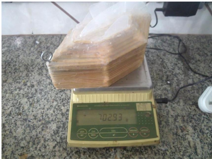
**Figura 15.** Aferição da massa do barco A.
