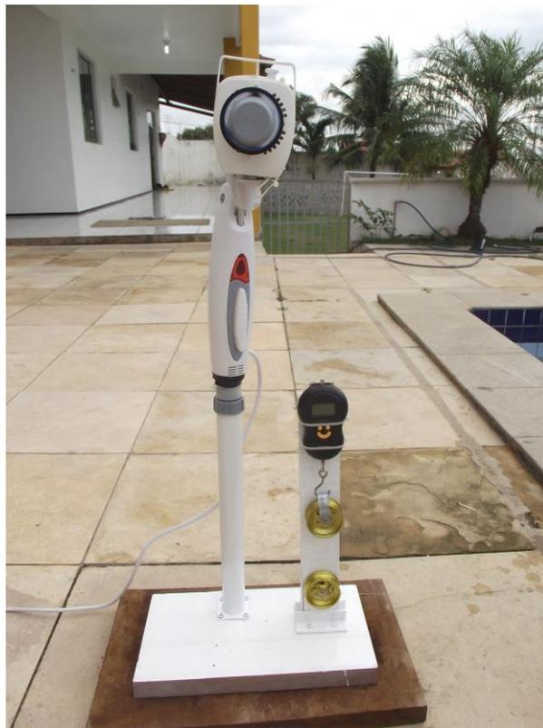
**Figura 9.** Medidor de Arrasto
