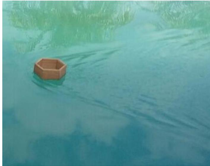
**Figura 21.** Separação da camada limite e região de esteira no barco B.
