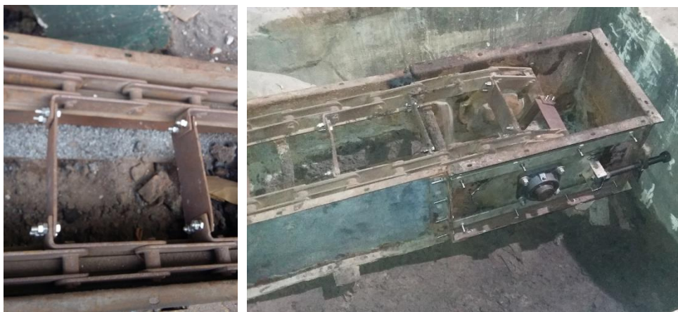
Figura (24) – Reforma do extrator de cinzas e redler. (Fonte: autor)
