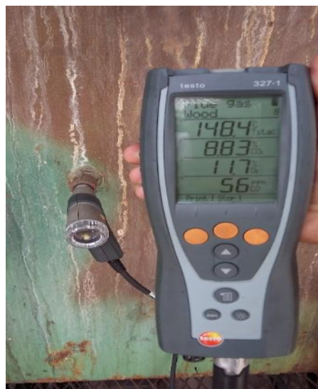
Figura (18) – Aparelho Testo 327-1 utilizado na medição dos gases de combustão. (Fonte: autor)
