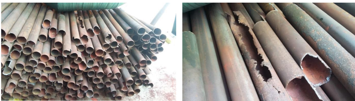
Figura (21) – Tubos vaporizadores corroídos, retirados da caldeira para substituição (Fonte: autor).
