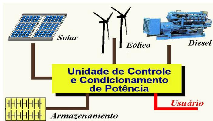
Figura 26 - Esquema de um sistema autônomo híbrido
