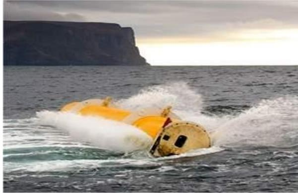
**Figura 33 - Conversor oscilante de onda**
