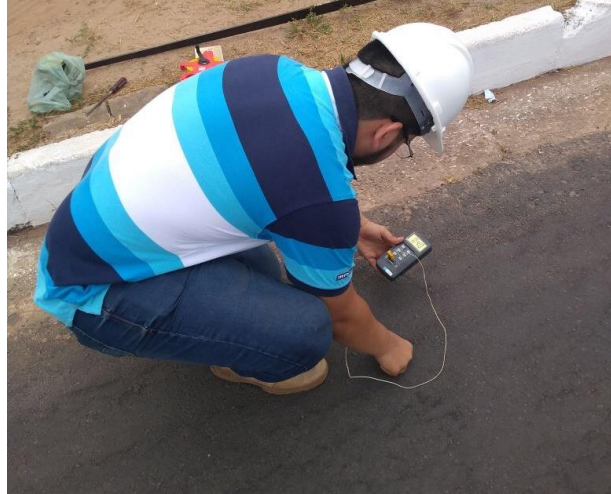
Figura 37 - Aferição da temperatura do pavimento
