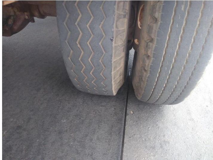
Figura 38 - Posicionamento da ponta de prova entre os pneus
