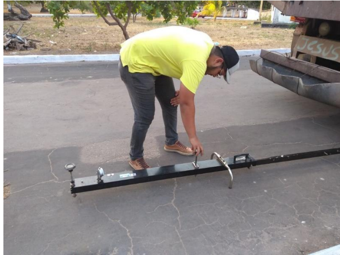
Figura 3 – Liberação da trava da viga
