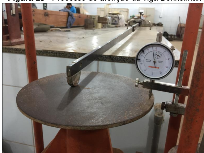
Figura 18 - Processo de aferição da viga Benkelman
