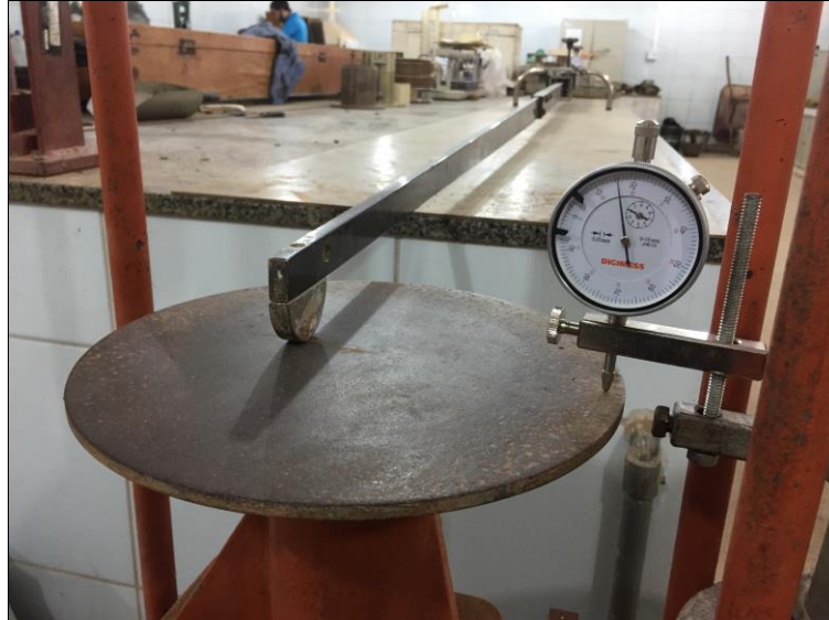
Figura 1 – Posicionamento do extensômetro e da ponta de prova no prato da prensa
