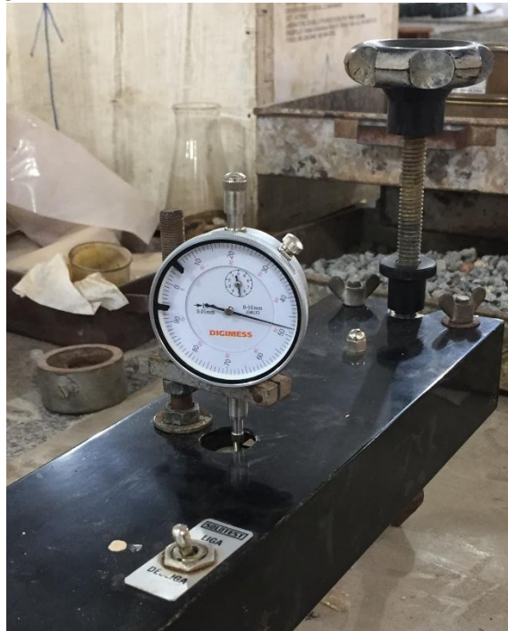
Figura 2 – Leitura no extensômetro conectado à viga
