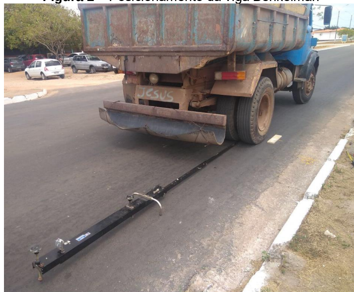
Figura 2 – Posicionamento da viga Benkelman
