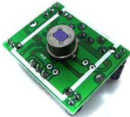
Figura 13 - Parte interna do Módulo PIR HC-SR501
