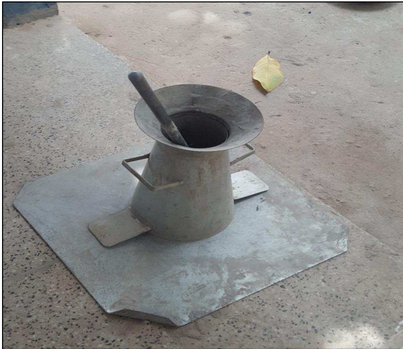
Figura 14 – Aparelhagem para execução do slump test .
