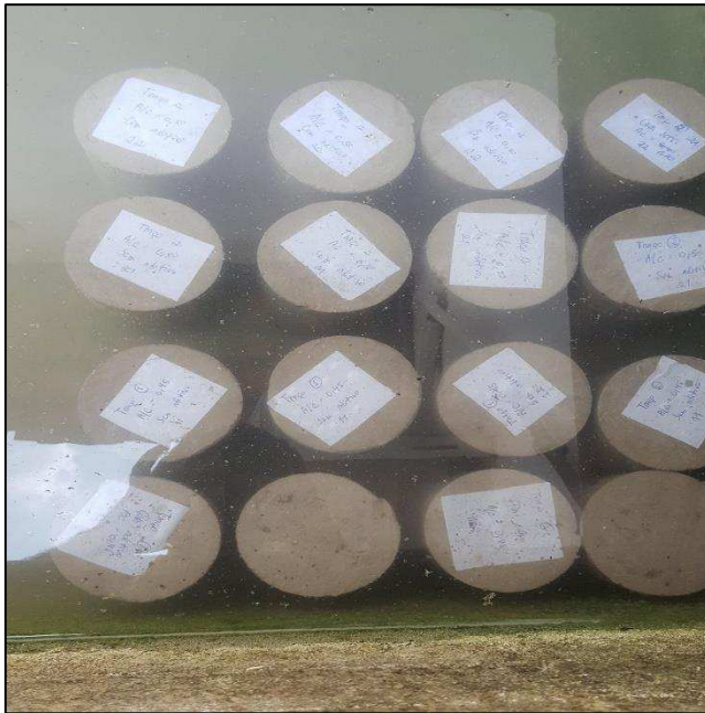
Figura 13 – Cura em tanque com solução saturada de \text{Ca(OH)}_2
