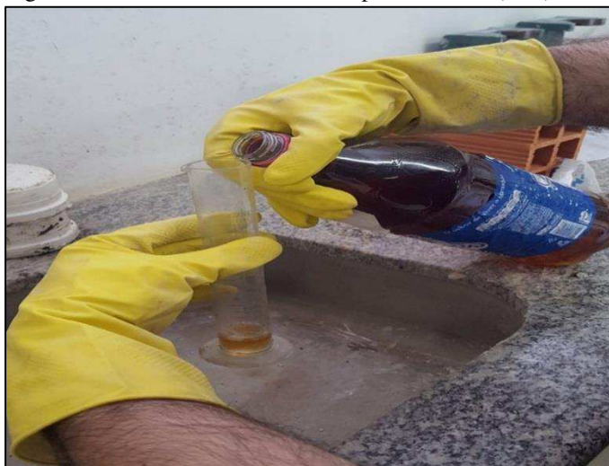
Figura 9 – Manuseio do aditivo incorporador de ar (IAR).
