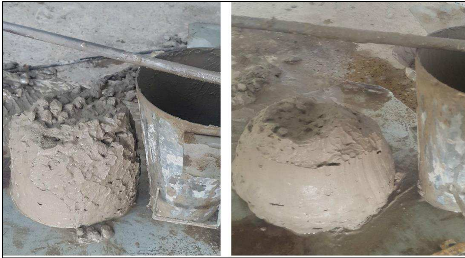
Figura 18 – Influência do aditivo incorporador de ar no abatimento do concreto.
