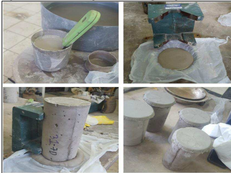
Figura 16 – Processo de capeamento dos corpos de prova.
