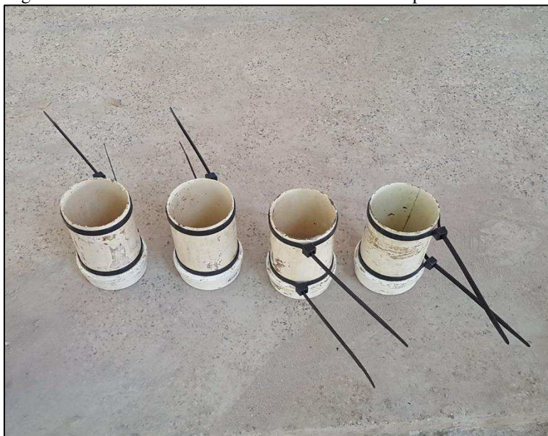
Figura 11 – Moldes cilíndricos de PVC com óleo nas paredes internas.
