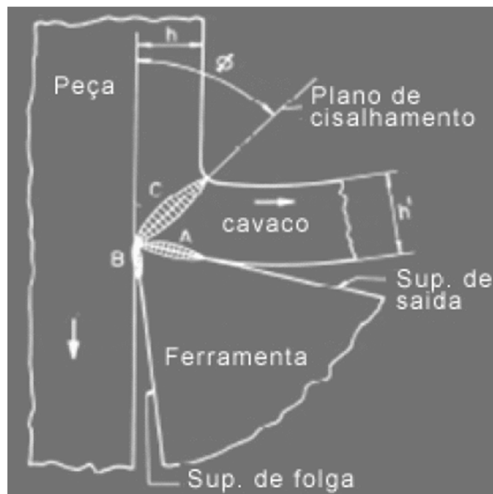
Figura 4.15 – Fontes de geração de calor na formação do cavaco, (adaptado de FERRARESI 1995).
