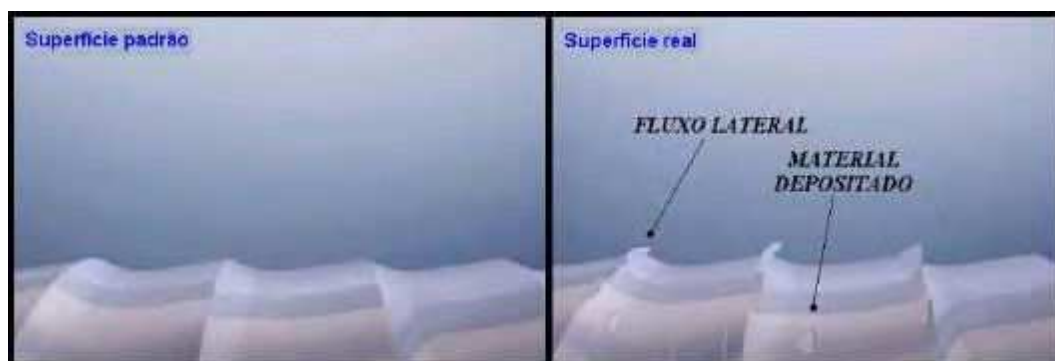
Figura 4.16 - Comparação da superfície teórica com a superfície real obtida em operações de torneamento (Cunha et al., 2005).
