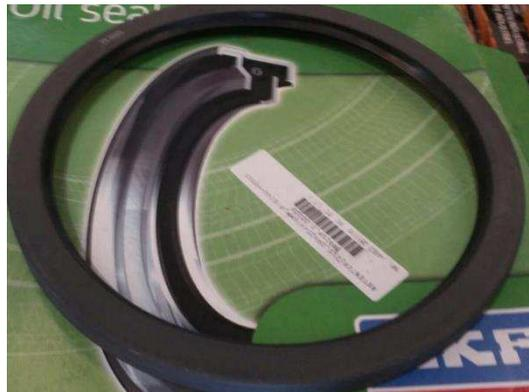
Figura 44: Imagem do retentor de vedação de nitrílica inteiro.
