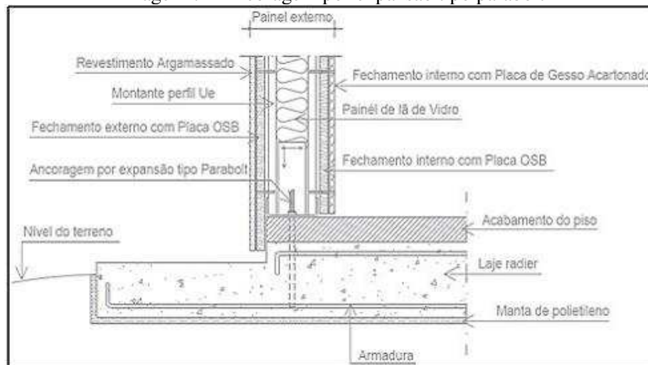
Imagem 7 - Ancoragem por expansão tipo parabolt
