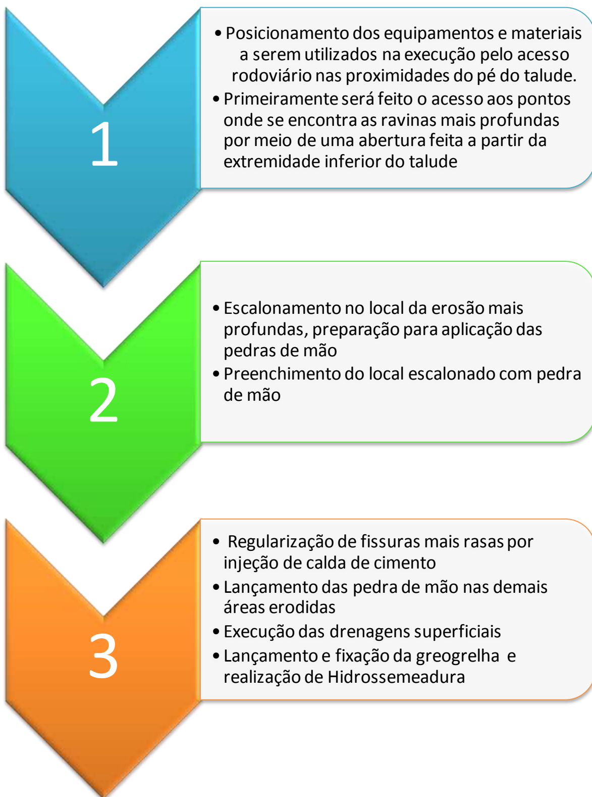
Figura 32: Fluxograma de execução de recuperação do talude
