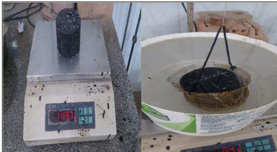
Figura 33 - Dosagem Marshall: Métodos de Determinação do Peso e do Volume dos CP's
