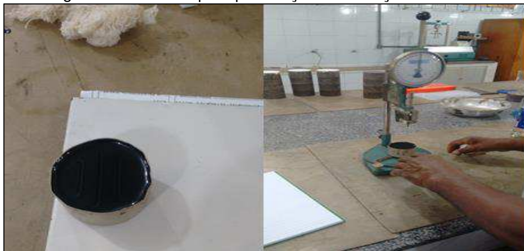
Figura 17 - Amostra para penetração e realização do ensaio
