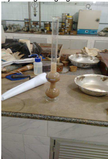
Figura 22 - Conjunto Água-agregado no Frasco Chapman
