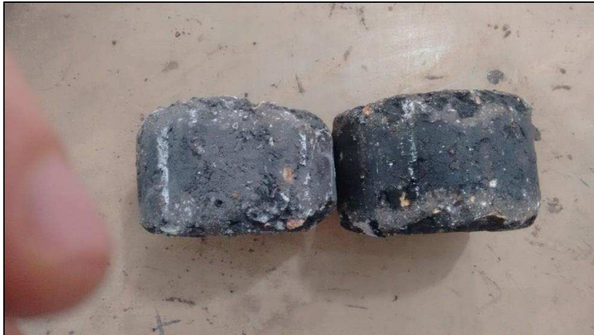
Figura 36 - CP's Após 300 Rotações da Máquina “Los Angeles”
