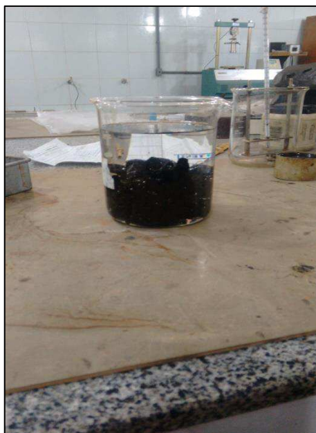
Figura 25 - Ensaio de Adesividade: mostra imersa em água após 72 horas
