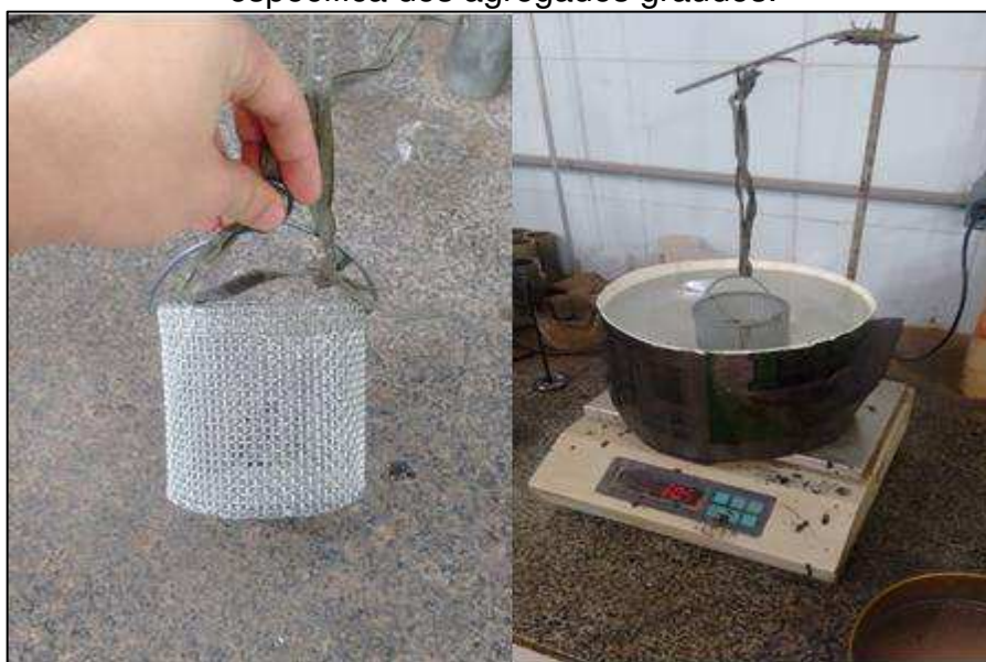
Figura 21 - Cesto Utilizado e Posicionado no Reservatório, para determinar a massa específica dos agregados graúdos.
