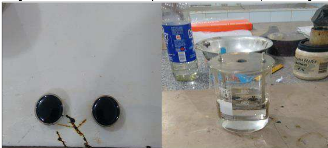
Figura 18 - Anel com CAP e Conjunto Posicionado no Béquer com Água
