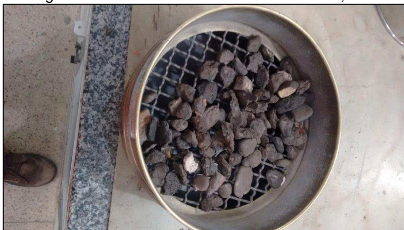
Figura 29 - Material Retido na Peneira de 12,7mm
