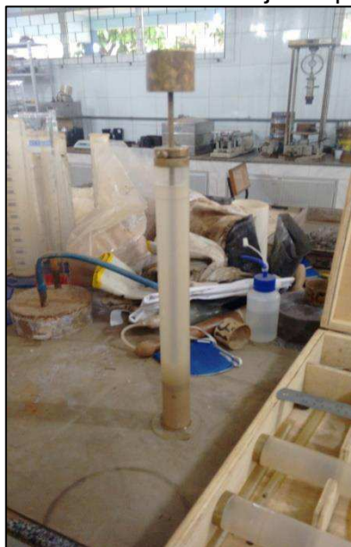
Figura 27 - Ensaio de Equivalente de Areia: conjunto proveta-pistão com agregado
