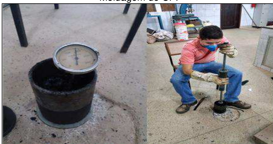
Figura 32 - Dosagem Marshall: Controle da Temperatura de Compactação e Moldagem do CP.
