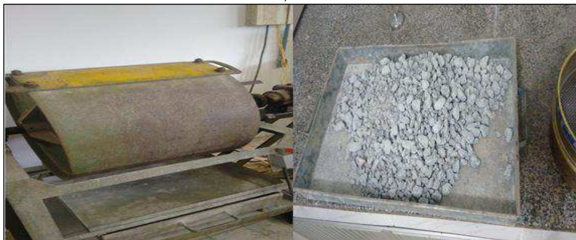
Figura 26 - Máquina “Los Angeles” e Amostra pronta para ser passada na Peneira de 1,7 mm.
