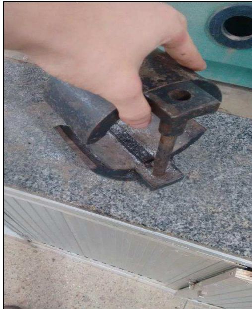
Figura 35 - Molde Específico para o Rompimento da Resistência a Tração
