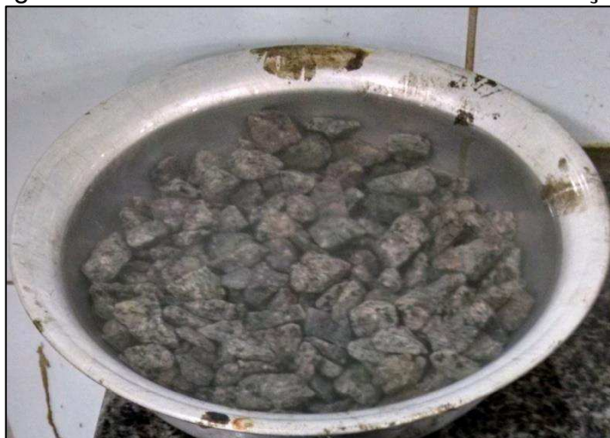
Figura 24 - Amostra Imersa no ensaio de Absorção
