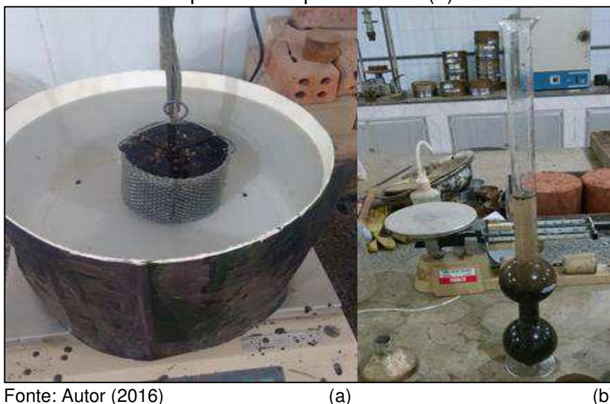
Figura 31 - Determinação do volume da parte gráuda (a) e realização da massa específica da parte miúda (b)
